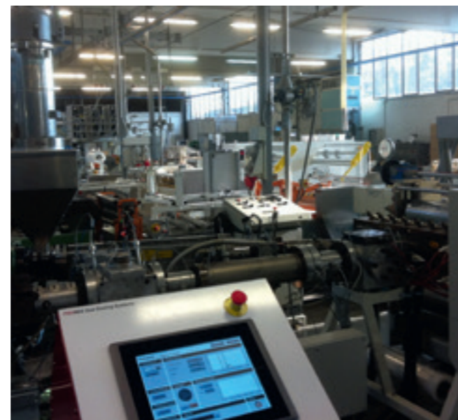
Promix N 2 - Dosieranlage als Bestandteil einer Schaum- extrusions-Linie
