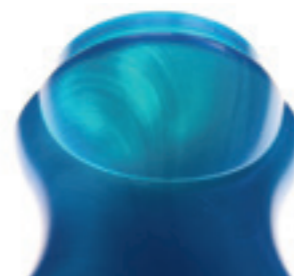
Deo-Gehäuse gespritzt ohne Promix Statikmischer
