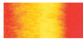
Thermoscan einer PE-Beschichtungsfolie ohne Promix Mischer
